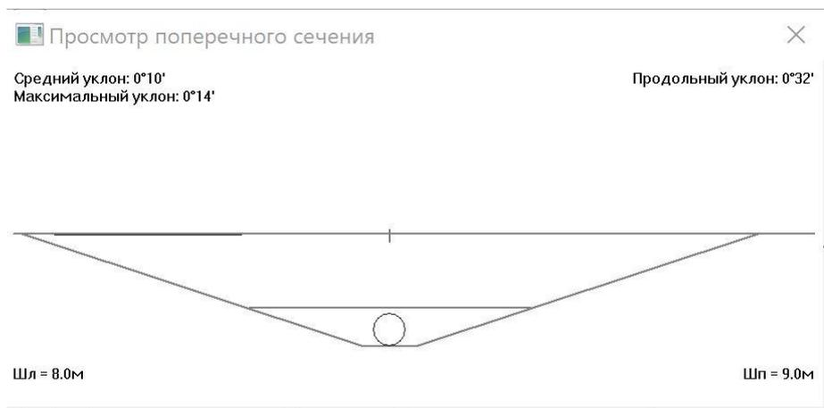
При создании участков траншеи важно знать текущий уклон линии рельефа на любом участке продольного профиля. Значение *продольного уклона* (в градусах и минутах) автоматически выводится справа в верхней части окна при перемещении курсора вдоль линии рельефа на продольном профиле. Слева в верхней части окна также выводятся среднее и максимальное значения поперечного уклона (в градусах и минутах). В нижней части окна выводятся ширина планировки рельефа слева и справа от оси траншеи.
