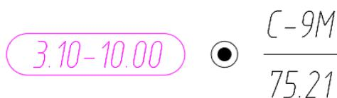
Скважина с интервалом глубин залегания мерзлых грунтов
