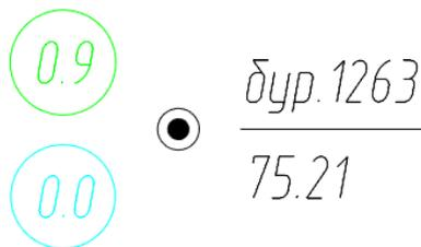
Обводненная скважина со слоем торфа мощностью 0.9 м
