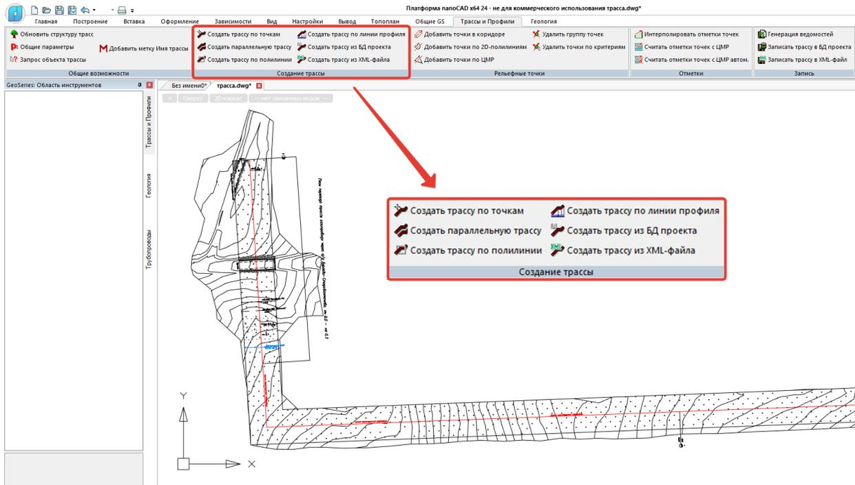
Для вызова функций редактирования трассы и создания новых объектов трассы (Вершины трассы, Пикетные точки, Объекты ситуации, Профили и пр.) используется вкладка **Трассы и Профили** панели **GeoSeries: Область инструментов**:
